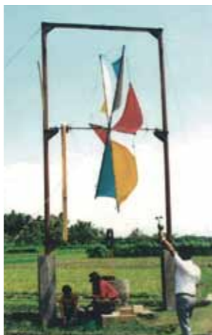
インドネシアにおける布製セイルによる揚水システム 伝統的なロープポンプは風車との整合性もよく、 安価で揚水効率も高い
