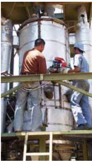
粘土を触媒とするバイオマスの流動接触分解ガス化装置 廃棄物系バイオマスをエネルギーとして利用する
