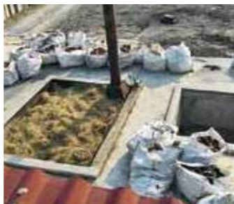
タイにおける山仙フル式炭化炉 動力を必要とせず、一度に大量の粉炭を生産可能
