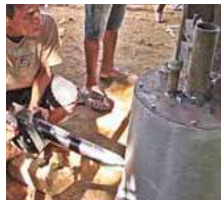
インドネシアの無電化村における炭のガス化発電装置 地域で生産した炭を用いて、村内に電力を供給
